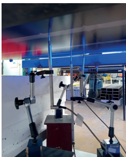
Photo 3. Layout of displacement sensors Fot. 3. Rozmieszczenie czujników przemieszczeń
