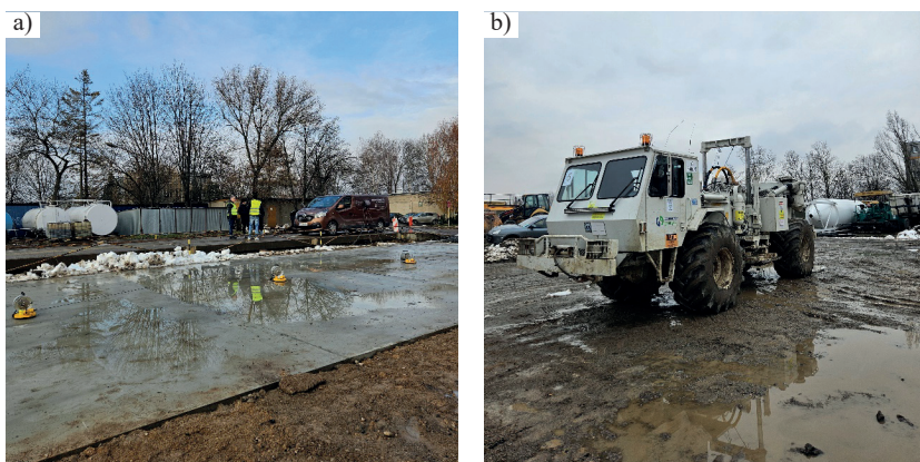
Photo 2. Sensor location (a) and view of the Mark IV exciter (b) Fot. 2. Lokalizacja czujników (a) oraz widok wzbudnika Mark IV (b)
