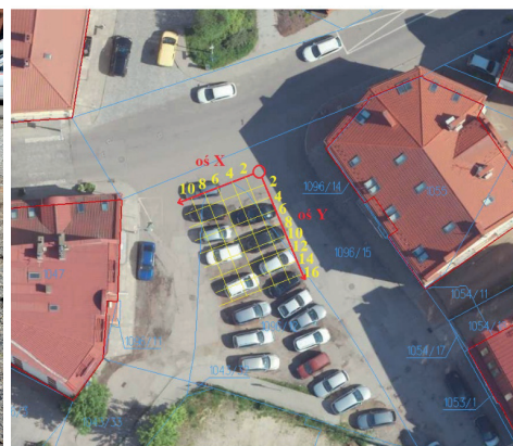
Fot. 2. Plan sytuacyjny obszaru badań georadarowych na placu Garncarskim w Rzeszowie wraz z siatką pomiarową i współrzędnymi profili Photo 2. Site plan of the GPR survey area at Garncarski Square in Rzeszów, including the measurement grid and profile coordinates
