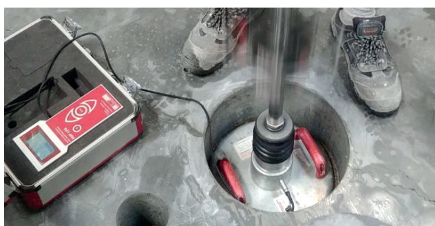
Photo 6. Example of soil testing using a light dynamic plate Fot 6. Przykład badania podłoża za pomocą lekkiej płyty dynamicznej
