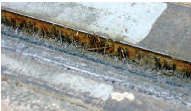
Photo 1. Traces of shearing of rolling edges at the cross grooves Fot. 1. Ślady ścinania krawędzi tocznych rowków krzyżownic
