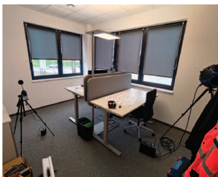
Photo 3. The source room (office room B.2.03) during the measurement of sound insulation Fot. 3. Pomieszczenie nadawcze (pokój biurowy B.2.03, poziom +4,00 m) podczas pomiaru izolacyjności akustycznej
