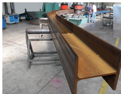
Photo 2. Test piece after bending Photo: author Fot. 2. Element badawczy po wygięciu Fot. autor
