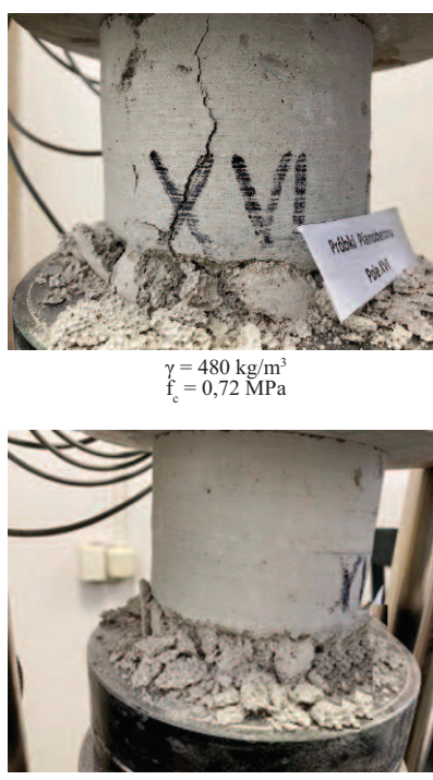
Photo 5. Image of destruction of foamed concrete samples made of two batches of foamed concrete mix Fot. 5. Obraz zniszczenia próbek pianobetonu wykonanych z dwóch zarobów mieszanki pianobetonowej
