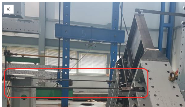
Photo 2. Bracing system of the testing stand: a) bracing implemented with tension rods; b) stabilisation implemented with rollers Fot. 2. Układ stężeń stanowiska badawczego: a) stężenia realizowane za pomocą cięgien; b) stabilizacja realizowana za pomocą rolek
