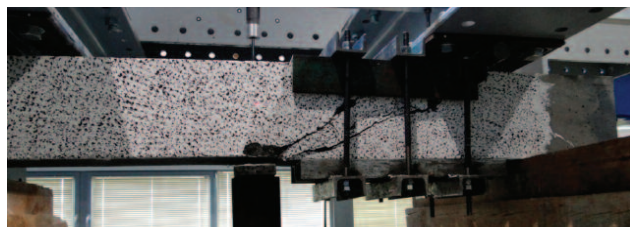
Photo 2. Beam reinforced with steel corset after the first testing stage Fot. 2. Widok belki wzmocnionej stalowym gorsetem, po pierwszym etapie badania
