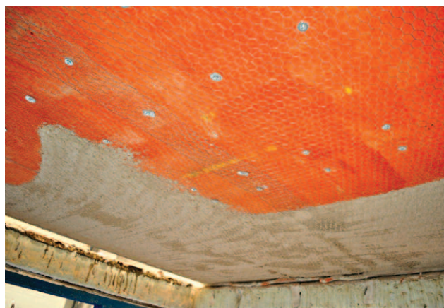
Fot. 1. Tynk gipsowy z siatką zbrojącą na elemencie nr 3 Photo 1. Gypsum plaster with reinforcing mesh on element no. 3
