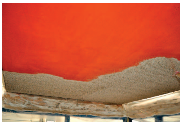
Fot. 2. Tynk gipsowy bez siatki zbrojącej na elemencie nr 4 Photo 2. Gypsum plaster without reinforcing mesh on element no. 4
