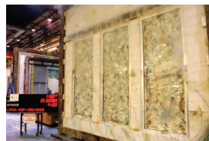
Fot. 2. Szyby zespolone z ramką 12 mm Photo 2. Double glazing with 12 mm frame
