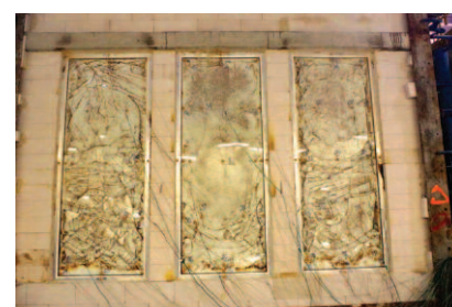
Fot. 3. Szyby zespolone z ramką 18 mm Photo 3. Double glazing with 18 mm frame
