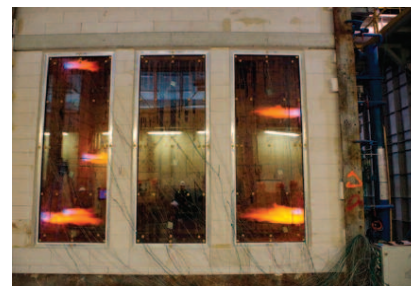
Fot. 2. Szyby zespolone z ramką 12 mm Photo 2. Double glazing with 12 mm frame
