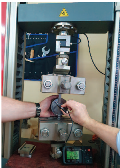
Fot. 2. Pomiar twardości w kierunku poziomym próbki umieszczonej w maszynie wytrzymałościowej
