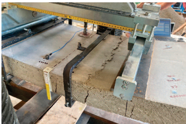
Fot. 2. Zniszczenie płyty o małym stopniu zbrojenia Photo 2. Damage of the slab with a low degree of reinforcement
