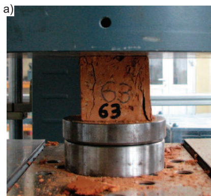
Badanie wytrzymałości cegieł i zapraw: a) próbka kostkowa z cegły w próbie ściskania; b) badanie zaprawy metodą stempla (DPT)
