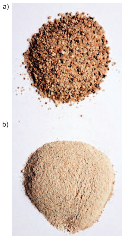
Fot. 1. Piasek normowy (a); mączka kwarcowa zmielona w dezintegratorze (b) Photo 1. Standard sand (a); quartz powder ground in a disintegrator (b)
