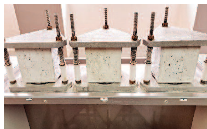
Fot. 3. Próbkę podczas badania głębokości penetracji wody
