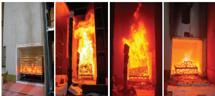
Fot. 2. Próbkę podczas badania wg metody europejskiej Photo 2. The samples during testing according to the European method
