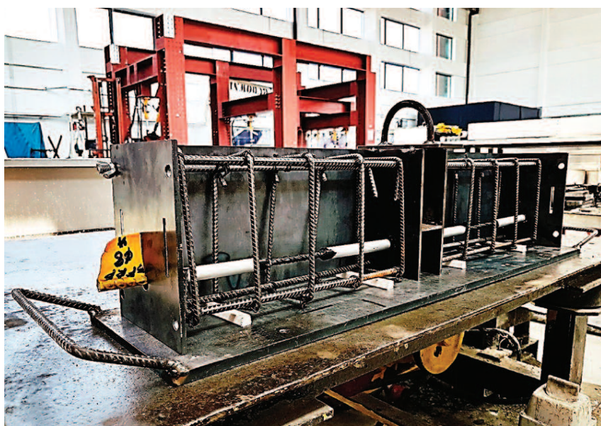
Zbrojenie próbki w trakcie montażu w formie. Jedynie centralny pręt kompozytowy jest przeprowadzany przez ściany formy. Pozostałe otwory, to otwory montażowe na śruby Sample reinforcement during assembly in the mol. Only the central composite bar is routed through the mold walls. The other holes are mounting holes for screws
