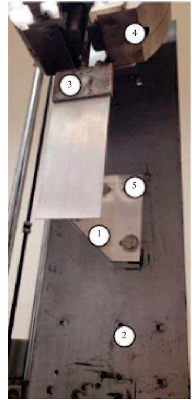
Widok próbki: 1 – konsola; 2 – podpora; 3 – adapter z frezem; 4 – głowica maszyny; 5 – śruba M8
