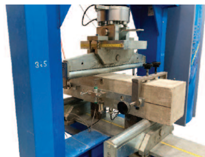
Stanowisko badawcze w przypadku testu 3PBT Testing set-up for 3PBT
