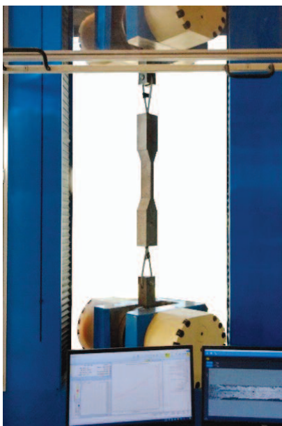
Fot. 1. Stanowisko badawcze w trakcie próby osiowego rozciągania Photo 1. Test setup during axial tension test
