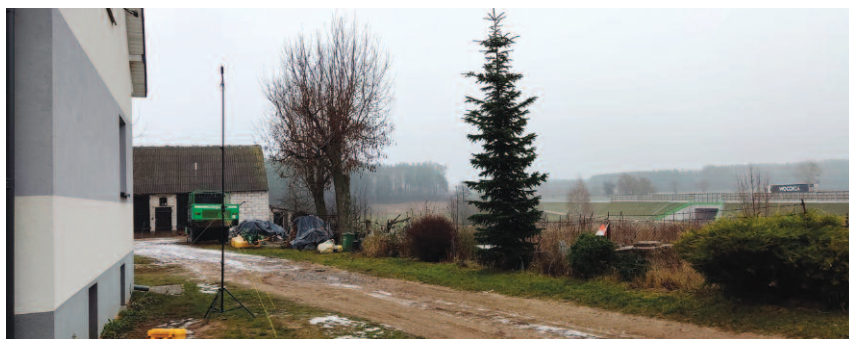
Fot. 2. Przykład badania efektywności ekranów – pomiar L_{Aeq} przy chronionym budynku Photo 2. Example of noise barrier efficiency test – L_{Aeq} measurement at protected building
