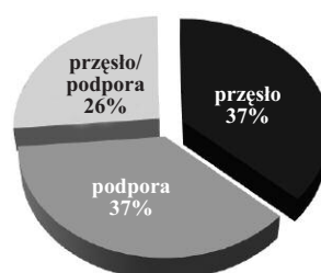
Rys. 3. Miejsce zniszczenia belki Fig. 3. Location of beams's failure
