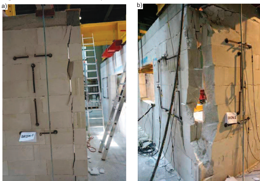
Fot. 2. Zniszczenie modeli bez zbrojenia: a) BKON-1; b) BKON-2
