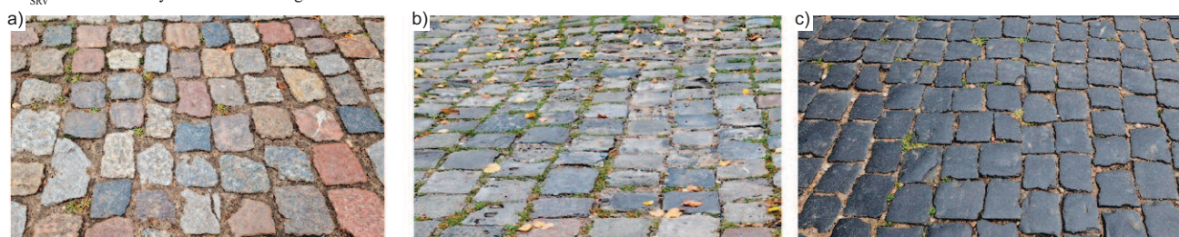
Fot. 2. Badane nawierzchnie: a) z kostek z kamienia polnego; b) z kostek żużlobetonowych; c) z kostek bazaltowych
