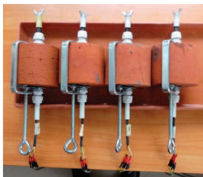
Fot. 3. Kalibracja czujników z wykorzystaniem rdzeni o średnicy 98 mm Photo 3. Calibration of sensors using ceramic cores with a diameter of 98 mm
