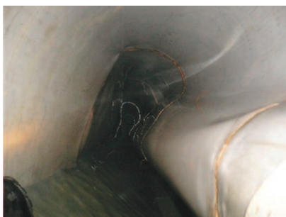
Fot. 1. Przykład utraty stateczności wykładziny CIPP [7]
