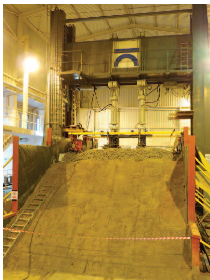
Stanowisko badawcze STEND wraz z modelem z zabudowanymi panelami STEND test stand with a model with built-in panels
