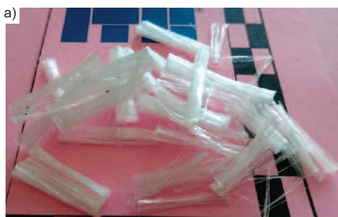
Fot. 2. Włókna: a) C 20 mm (fibrylowane); b) C – po rozwinięciu Fig. 3. Fibers: a) C 20 mm (fibrillated); b) C – after unfolding
