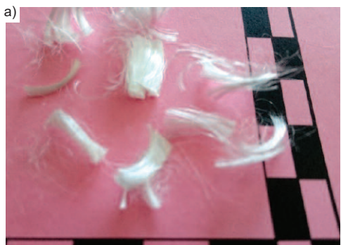
Fot. 1. Włókna: a) A 23 μm/12 mm; b) B 30 μm/6 mm Fig. 1. Fibers: a) A 23 μm/12 mm; b) B 30 μm/6 mm
