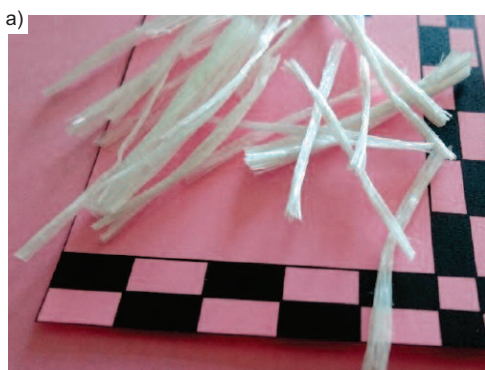
Fot. 3. Włókna: a) D 40 mm (fibrylowane); b) D – po rozwinięciu Fig. 5. Fibers: a) D 40 mm (fibrillated); b) D – after unfolding
