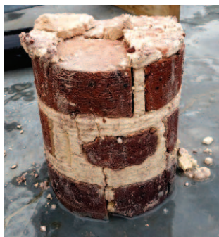
Fot. 3. Odwiert rdzeniowy przez strop ceglany Photo 3. Core drilling through a brick ceiling
