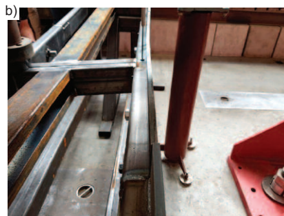
Fot. 6. Wynik badania modelu bariery z łącznikiem: a) połączenie na trzpień z zawleczką dolnego pasa; b) połączenie śrubowe dolnego pasa
