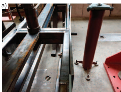
Fot. 6. Wynik badania modelu bariery z łącznikiem: a) połączenie na trzpień z zawleczką dolnego pasa; b) połączenie śrubowe dolnego pasa
