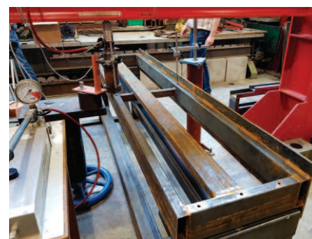
Fot. 3. Stanowisko podczas badań statycznych barier tymczasowych Photo 3. Test stand during static laboratory tests of temporary barriers
