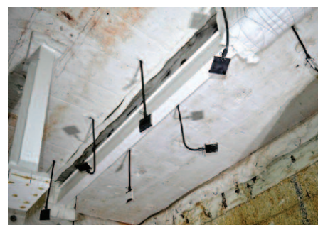
Fot. 1. Belka B1 i element UB1 przed badaniem
