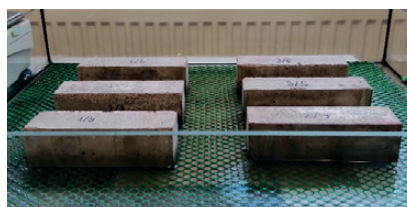
Fot. 1. Badanie nasiąkliwości próbek Photo 1. Testing the absorption of samples
