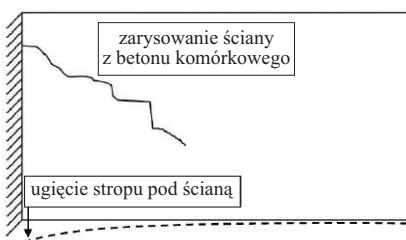
Rys. 1. Zarysowanie ukośne ściany działowej wewnątrz mieszkaniowej w obszarze połączenia ze ścianą międzymieszkaniową Fig. 1. Diagonal scratching of the partition wall inside the apartment in the area of connection with the interhousing wall
