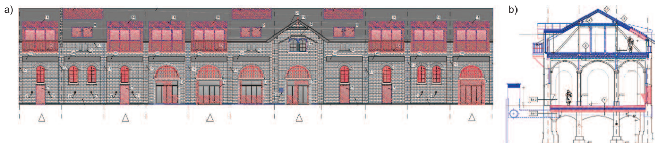
Rys. 2. Projekt Archicom Studio Projekt z 2020 r. dotyczący przebudowy Stajni nr 3 na budynek usługowo-mieszkalny. Kolorami czerwonym i niebieskim oznaczono wyburzenia i nowe elementy budowlane: a) centralny fragment elewacji południowej; b) przekrój poprzeczny [5]
