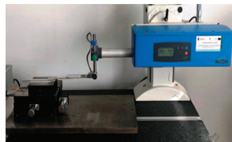
Fot. 2. Badanie chropowatości powierzchni stalowych włókien – stanowisko pomiarowe
