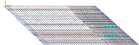
Rys. 6. Ustawienie 3, pojazd K nad obszarem zarysowania płyty w narożu ostrokatnym osi nr 2
