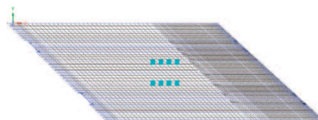
Rys. 5. Ustawienie 2, pojazd K ustawiony nad środkiem krótkiej przekątnej mostu
