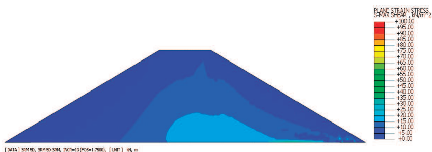
Rys. 12. Maksymalne naprężenia ścinające, korpus wału z odpadów wydobywczych wzmocnionych wapnem, 5 doba piętrzenia wody (FoS = 1,75) Fig. 12. Maximum shear stresses, shaft body made of lime-reinforced mining waste, five days of water damming (FoS = 1.75)
