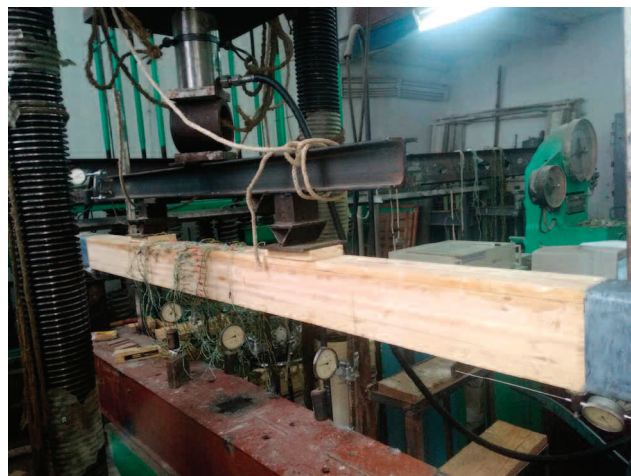
Fot. 2. Belka wykonana z drewna klejonego warstwowo ze zbrojeniem mieszanym pod obciążeniem
