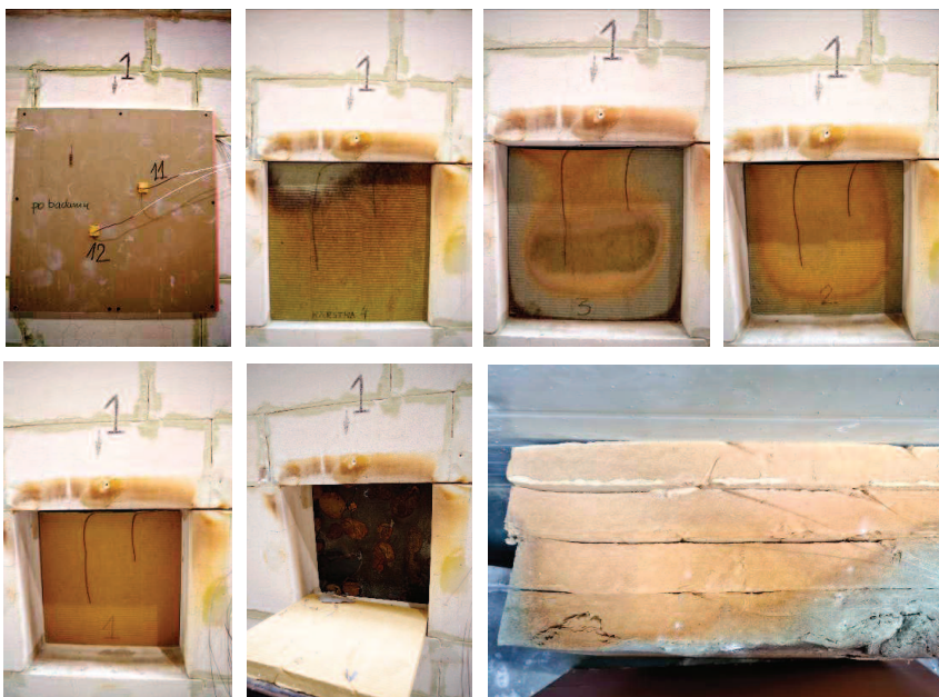
Fot. 2. Widok wybranej wełny mineralnej po badaniu ogniowym, w kolejności od strony nienagrzewanej
