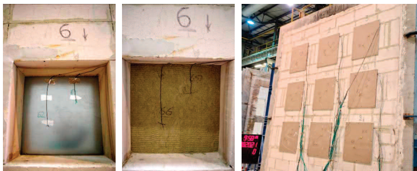
Fot. 1. Fazy montażu elementu wybranego typu wełny mineralnej
