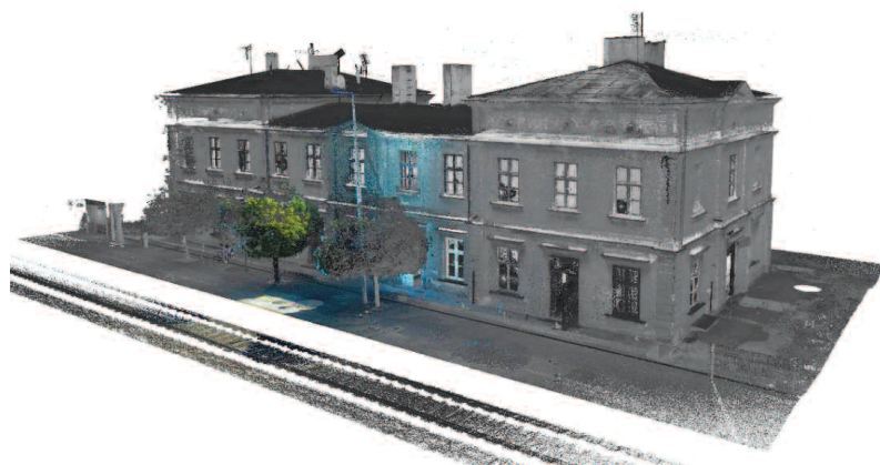
Fot. 1. Dworzec w Rokicinach – połączona chmura punktów Photo 1. Rokiciny railway station – a connected point cloud
