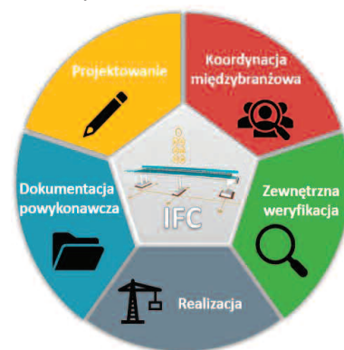
Rys. 1. Model cyfrowy (plik IFC) jako podstawa całego procesu projektowego Fig. 1. Digital model (IFC file) as the basis for the entire project of cycle
