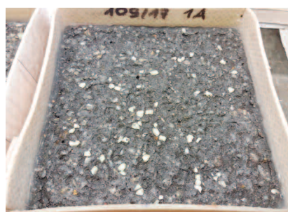
Fot. 2. Próbkę o największej destrukcji mrozozy w środowisku soli odladzających Photo 2. The sample with the largest frost destruction in deicing salts
