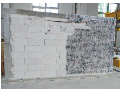
Fot. 3. Zarysowanie modelu MS-Z2-2
