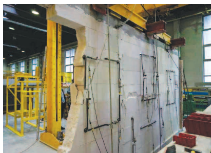
Fot. 2. Zarysowanie modelu MNS-Z2-1
