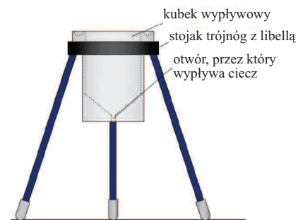
Rys. 1. Schemat stanowiska do badania lepkości kinematycznej płynnej żywicy epoksydowej
