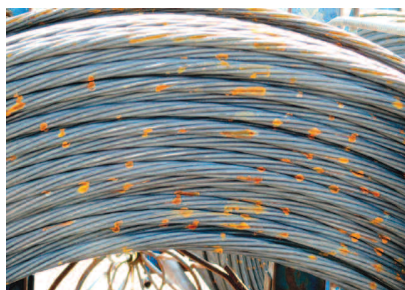
Ogniska korozji na splotach wadliwie składowanych
