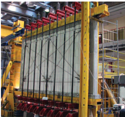
Widok modelu ściany skrępowanej w stanowisku badawczym
