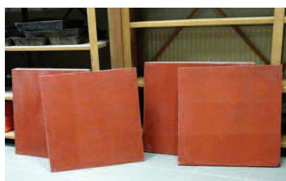
Fot. 1. Próbkę wyciętą z płyt elewacyjnych, przygotowane do oceny wizualnej
