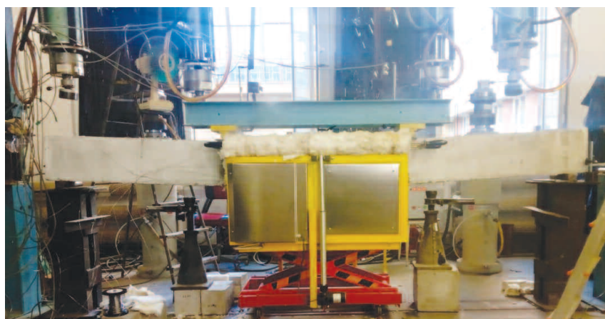
Usytuowanie belki w piecu podczas badań
