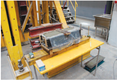
Fot. 2. Badanie skurczu swobodnego. Widok stanowiska badawczego
